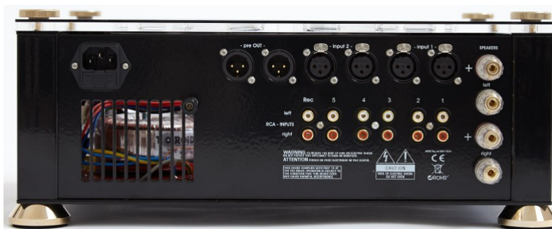
Обилие разъемов на задней панели, включая балансные, есть даже выходы на акустические системы
